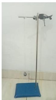
**Gambar 1.** Susunan alat pengambilan data bandul matematis sederhana
