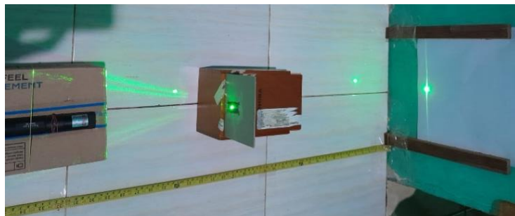
Gambar 1. Alat percobaan sederhana difraksi Fraunhofer tanpa objek
